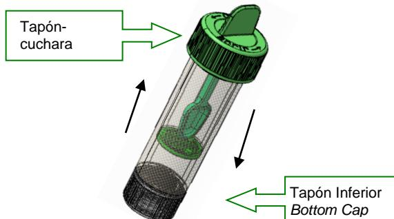
2. Cambiar el tapón inferior del tubo por el cono de sedimentación
